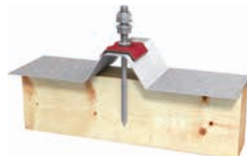
JA3-SB-8.0xL con rondella di tenuta E16 + calotta ORKAN per profili grecati
